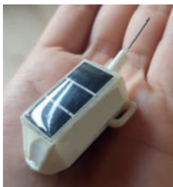
Foto 2. Dispositivo GPS utilizzato nella ricerca “Nibbio bruno e Airone rosso”. Strumento dal peso di circa 20 g (meno del 2% del peso corporeo)
